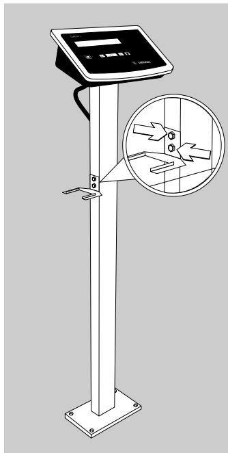
Sulla colonna può essere avvitato il supporto di appoggio di un lettore di codici a barre (YBH01CWS).
