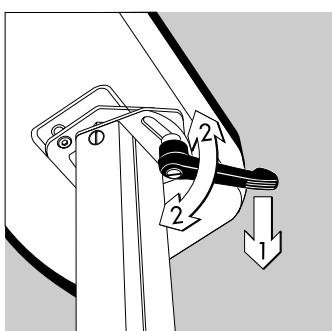
Il est possible de tourner l'indicateur autour d'un axe vertical vers la gauche ou vers la droite lorsque la colonne est fixe.
