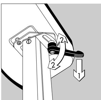
El visor puede girarse –con columna de soporte fija– hacia la izquierda y derecha, respecto al eje vertical.
