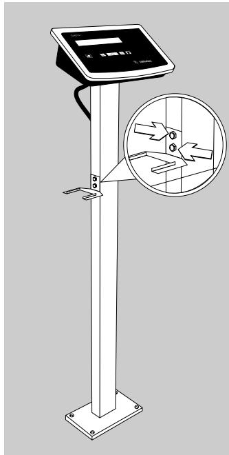
An die Stativsäule kann die Ablagefläche für einen Barcodeleser (YBH01CWS) angeschraubt werden.
