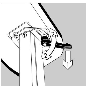
Das Auswertegerät kann bei feststehender Stativsäule um die vertikale Achse nach links und rechts gedreht werden.
