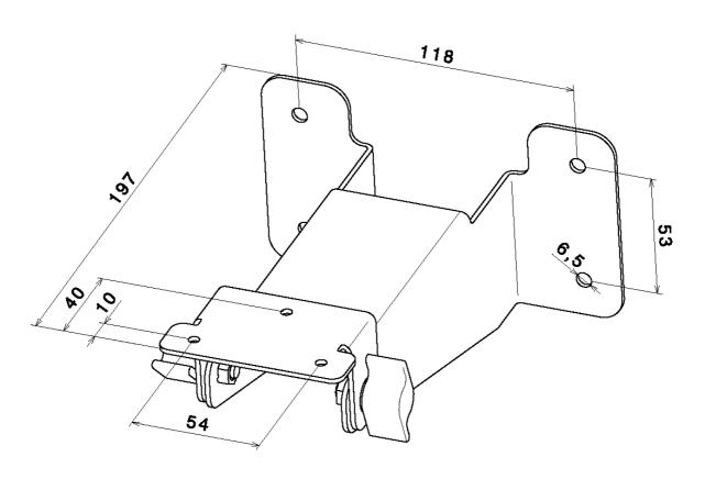
Alle Maßangaben in Millimeter. Der montierte Indikator ist kippbar.
