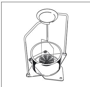
Dichtebestimmung von Festkörpern, Dichte höher als die der Tauchflüssigkeit:
