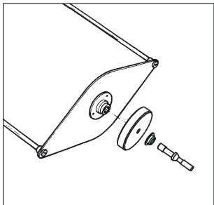
Visser l'adaptateur correspondant sur le dessous de la structure de suspension :
