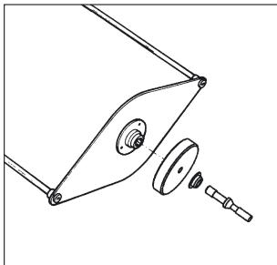
Schrauben Sie den entsprechenden Adapter von unten in den Gestellboden ein:
