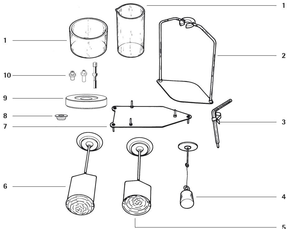
1 Bechergläser ( $\varnothing$  76 mm u.  $\varnothing$  55 mm)
