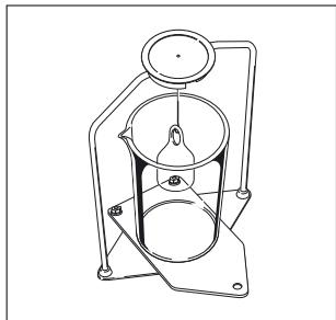
Dichtebestimmung von Flüssigkeiten:
