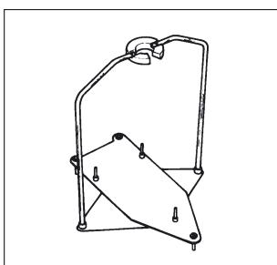
Die Brücke zur Aufnahme des Becherglases stellen Sie bitte durch das Gestell hindurch auf den Wägeraumboden auf, bei BA-, BP-, CPA-, CP- und ME-Waagen mit den weiter auseinanderliegenden Stiften nach unten, bei MC/RC-Waagen mit den inneren Stiften nach unten.
