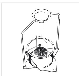
Dichtebestimmung von Festkörpern, Dichte geringer als die der Tauchflüssigkeit:
