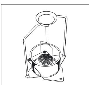
Pour déterminer les masses volumiques de solides quand elles sont inférieures à celle du liquide d'immersion, utiliser :
