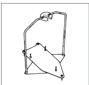
Utiliser le pont métallique pour supporter le bêcher. Positionner ce pont sur le plateau de la structure de façon à ce qu'elle repose sur la base de la chambre de pesée. Pour les balances BA, BP, CPA, CP et ME, le pont repose sur les pieds extérieurs.
